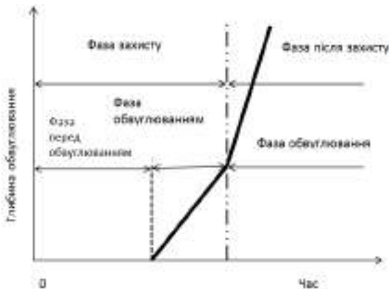
Рис. 1. Фази обвуглювання захищеної деревини
