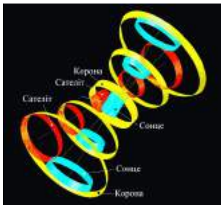
Рисунок 2 — Схема створення гіперболічних планетарних диференціалів (без ядра)
