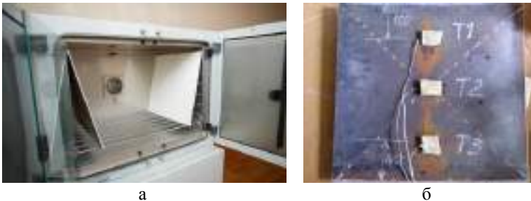
Рисунок 1 – Проведення експериментальних досліджень (а – проведення пришвидшених кліматичних випробувань вогнезахисного покриття в кліматичній камері BINDER KBF 240; б – підготовка зразків до вогневих випробувань).
