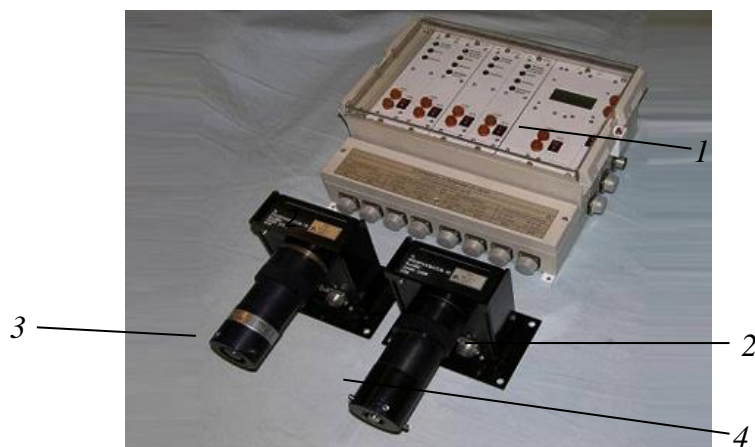
Рисунок 2 - Внешний вид одного комплекта системы РГС-07: 1 – блок управления, питания и сигнализации; 2 – системный преобразователь; 3, 4 – аналитический преобразователь
