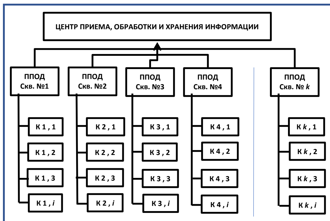
Рисунок 1 - Структура системы мониторинга за фильтрационными процессами
