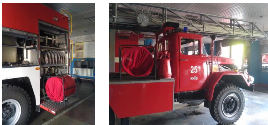
Рис. 4. Можливі варіанти розміщення піногенераторів на пожежних автомобілях
