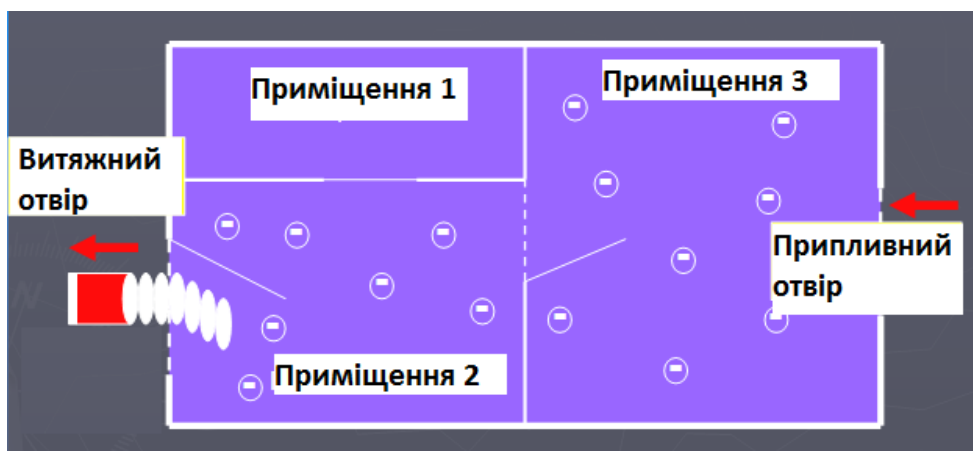
Рис. 3. Загальна схема організації відсмоктування продуктів горіння за допомогою переносних засобів димо- та тепловидалення
