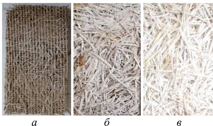
Рис. 1. Модельні зразки теплоізоляційного матеріалу: a – на основі деревинна шерсть – неорганічне в'язуче при співвідношенні 1:1, б – на основі деревинна шерсть – неорганічне в'язуче при співвідношенні 1:2; в – на основі деревинна шерсть – органо-мінеральне в'язуче при співвідношенні 1:1
