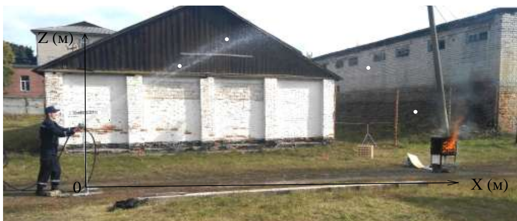
Рис. 1. Формирование экспериментальных данных для аналитического построения траекторий движения струй, подаваемых установкой АУГГОС-М.
