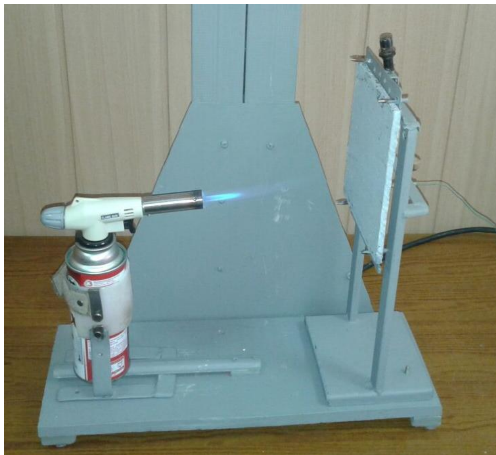
Рис. 3. Внешний вид установки исследования теплозащитного действия ГОС на стальные элементы резервуара
