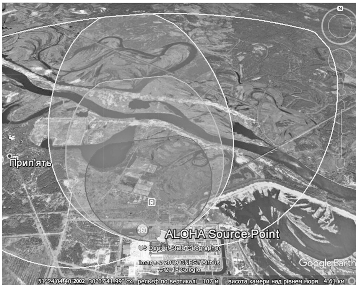
Рисунок 3 — Зона радіоактивного забруднення атмосфери під час аварії на Чорнобильській АЕС на момент 102 хв від вибуху реактора: S_{НС} = 23 \text{ км}^2
