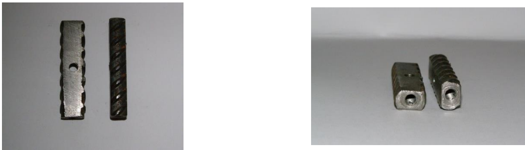
Рис. 3. Зовнішній вигляд зразків з арматури \varnothing 12 класу A400C
