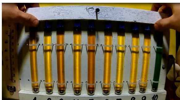
Рисунок 4 – Заливання масла – а. Герметизація пробірок – б [26]
