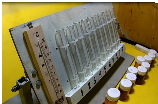
Рисунок 2 – Стенд для проведення експериментів – а. Розливання масла – б [26]
