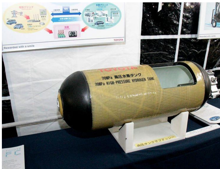
Рисунок 3 – Паливний бак для водню Тойти (toyota-hydrogen-high-pressure-tank)
