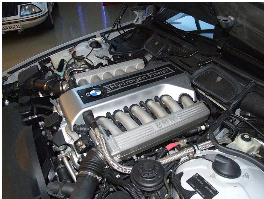
Рисунок 7 – 12-циліндровий двигун BMW Hydrogen 7 об'ємом 6 літрів [58]
