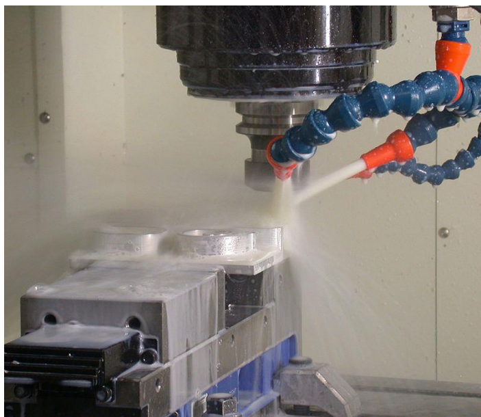
Рисунок 1 – Приклад використання та застосування змащувально-охолоджуючої рідини на водяній основі, при обробці алюмінієвої заготовки на фрезерній станції з ЧПУ [52]
