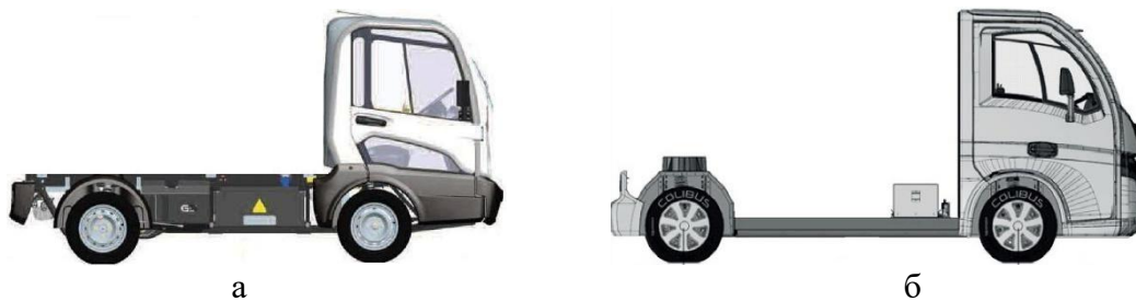
Рисунок 2 – Електромобілі, створені за компоувальною схемою "CoA": а) – модельного ряду "Goupil G5"; б) – модельного ряду "Colibus"
