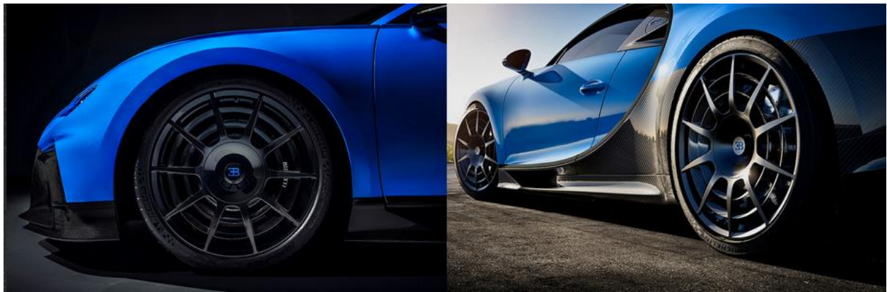
Рисунок 13 – «Ультралегкі» диски з магнієвого сплаву на Bugatti Chiron Pur Sport [75]
