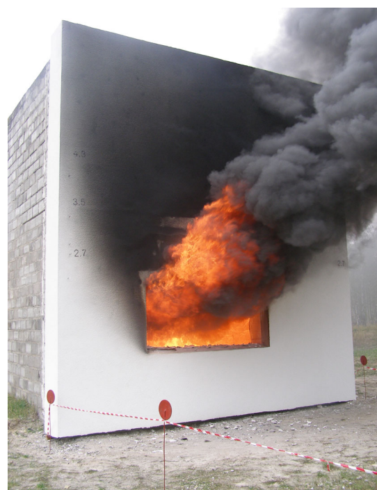
Рис. 2 Вид фрагмента будинку під час проведення випробувань
