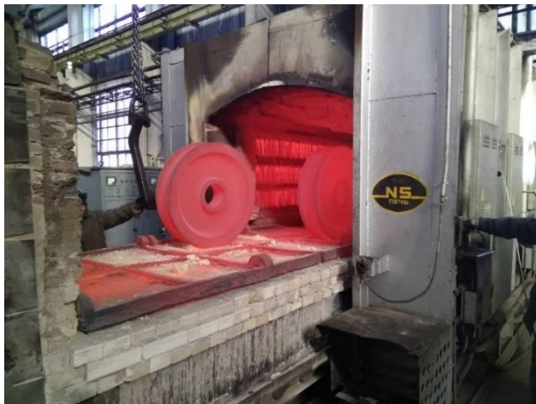
Рис. 2. Термообробка ходових коліс мостового крану
