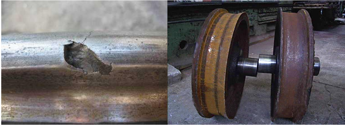
Рис. 1. Зношені реборди кранових коліс
