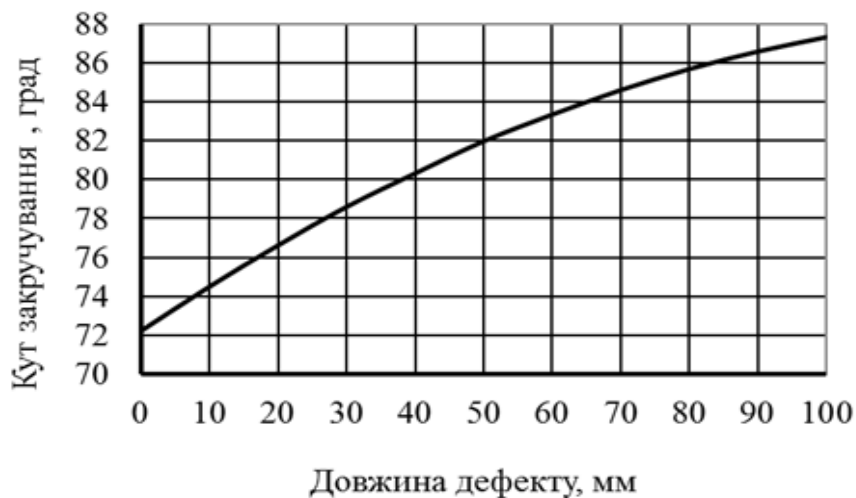
Рис. 4. Експериментальна залежність кута закручування рукава \varnothing 51 мм від довжини дефекту по утку
