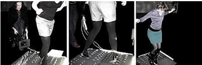
Рис. 1. Пол с пьезогенераторами в лондонском клубе
