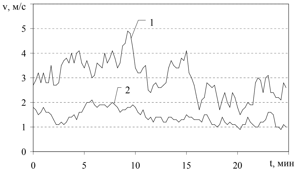
Рис. 3 – Полученная в ходе эксперимента реализация вектора (v_x, v_y) скорости ветра: 1 – v_x ; 2 – v_y
