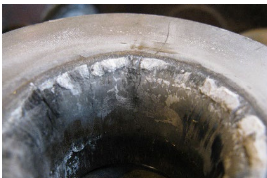
Рисунок 1 – Картина зносу матриці трубопрофільного пресу, [6]
