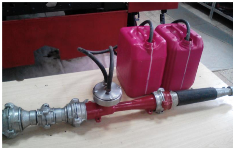
Рис. 2. Внешний вид портативного устройства эжекционного типа для получения огнетушащего геля
