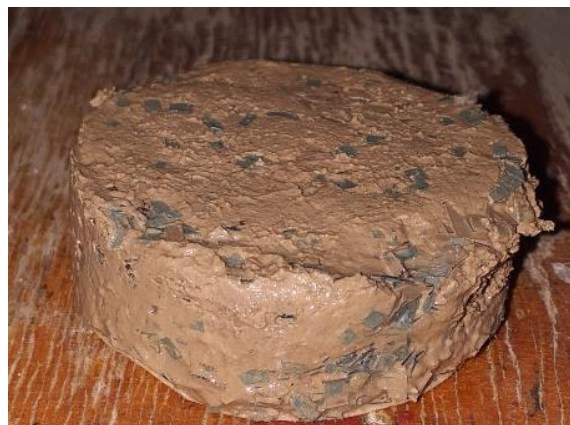
Рис. 1. Загальний вигляд водонасиченого зразку суглинку лесованого тугопластичного та подрібненого пластику до 2 мм у співвідношенні 90:10
