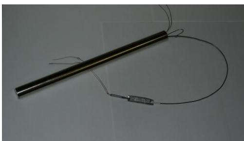
Рис. 1. Самокалібрований датчик температури
