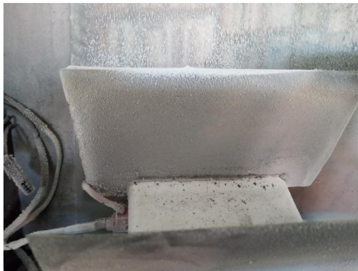
Рис. 5. Нерівномірний розподіл осілих твердих часток по площі пластин-електродів
