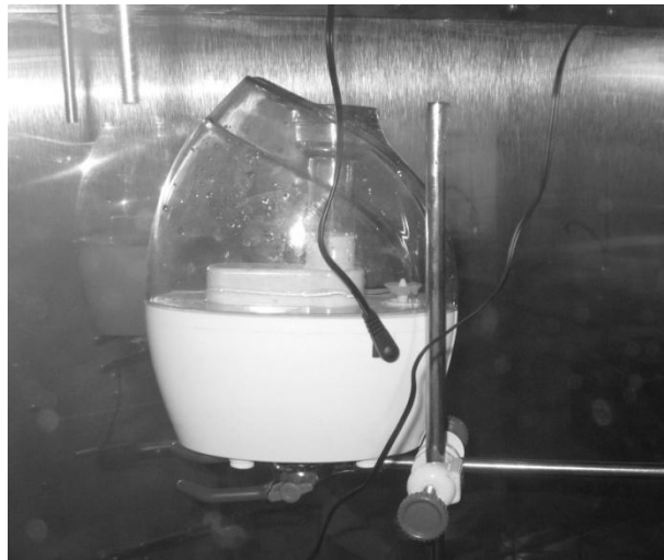
Рис. 6.8. Ультразвуковий диспергатор рідини NU 0802
