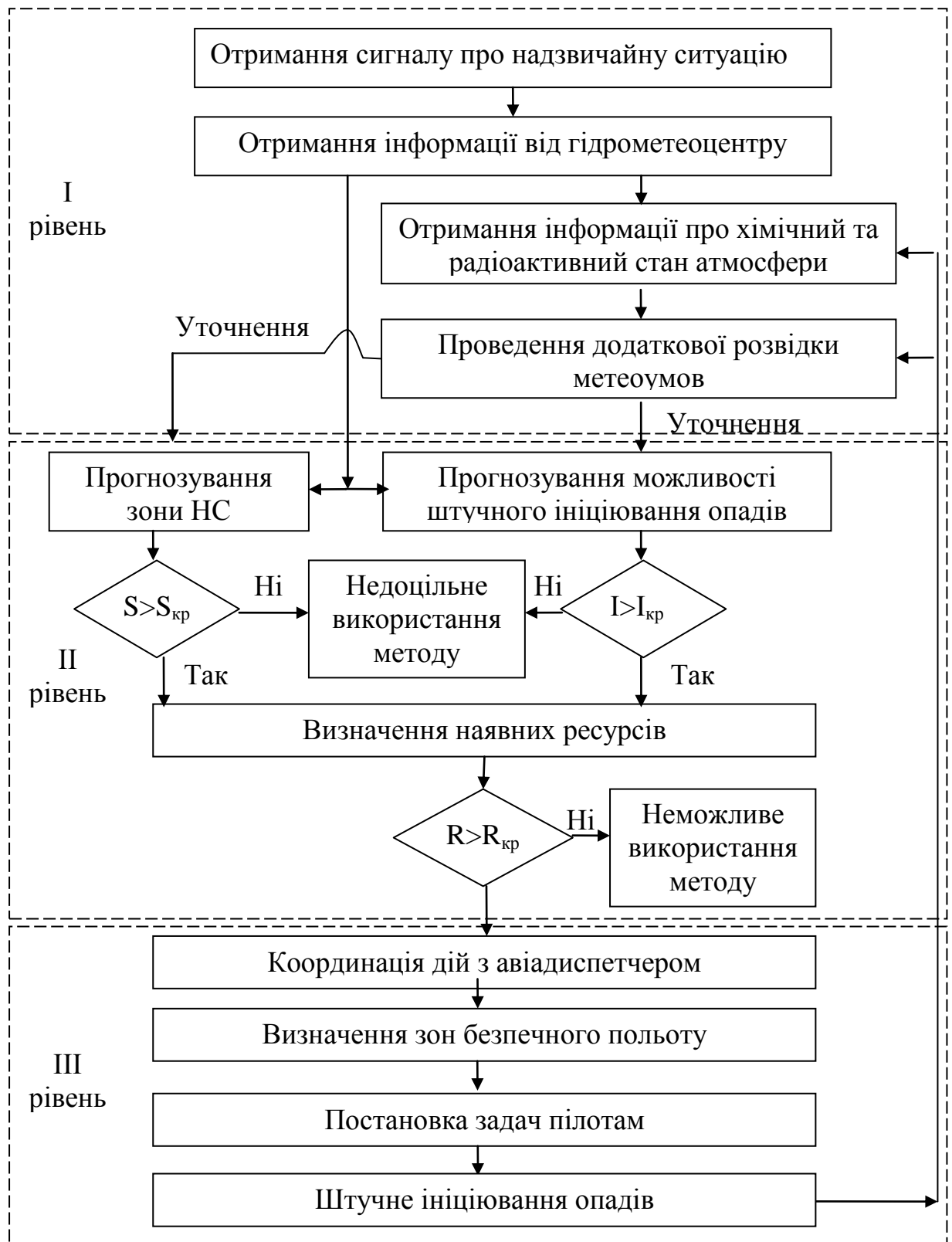
Рис. 4.19. Керуючий алгоритм реалізації організаційно-технічного методу ліквідації наслідків надзвичайних ситуацій природного та техногенного характеру шляхом осадження з атмосфери небезпечних газоподібних та дисперсних речовин
