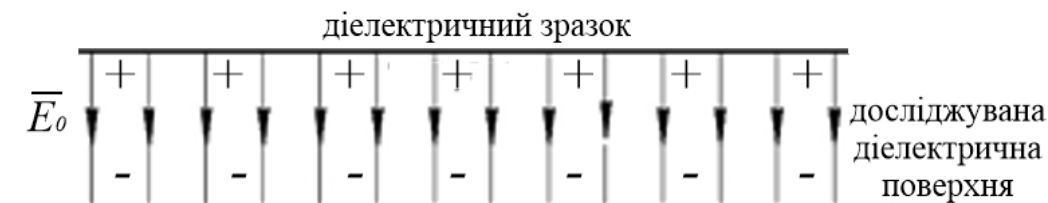
Рис. 1. Схема зарядження ділянки плоскої поверхні при її терті по діелектричній поверхні зразка
