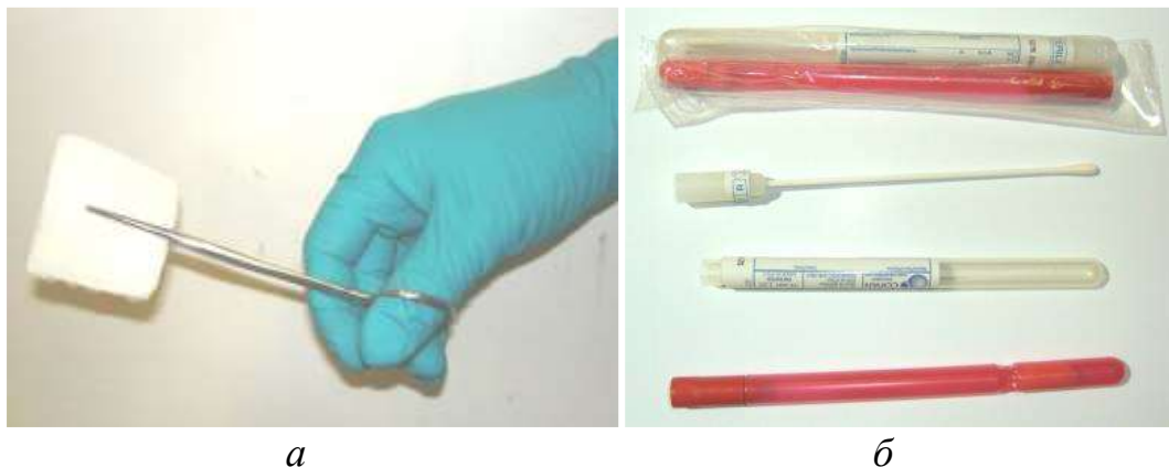
Рис. 1 – Тампони та серветки для зразків ( а – хімічні; б – біологічні)
