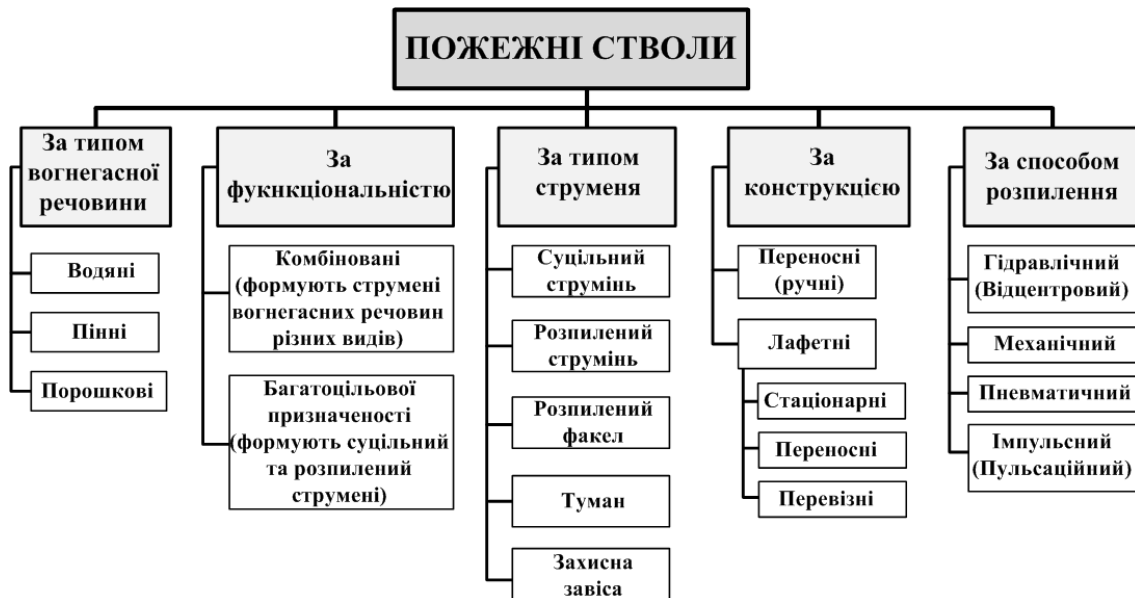
Рис. 1. – Класифікація пожежних стволів
