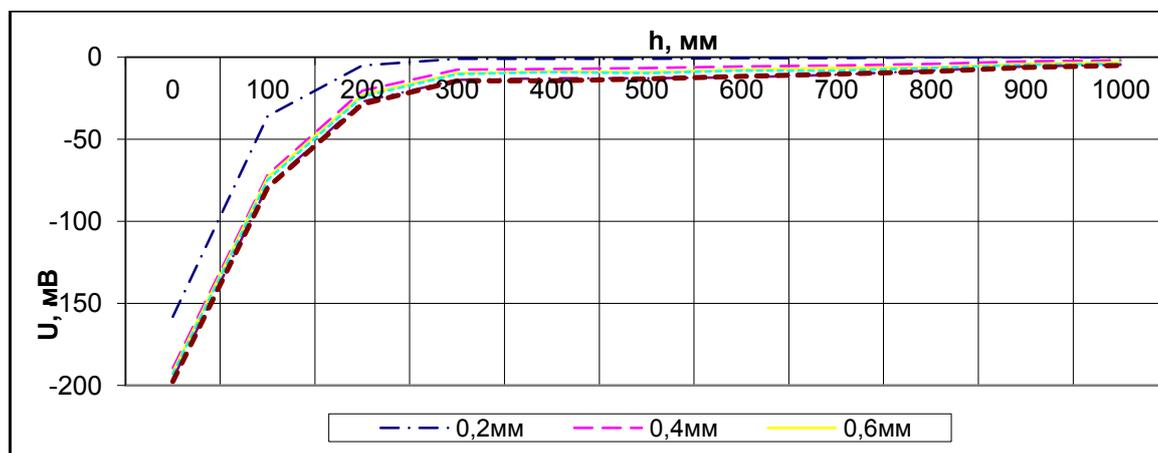
Рис. 1. Зависимость наводимой разности потенциалов заряженными частицами пламени от высоты установки ЧЭ над пламенем и от диаметра проводников ЧЭ
