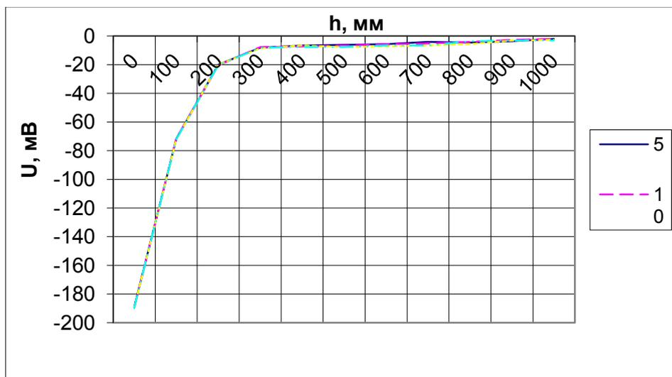
Рис. 3. Зависимость наводимой разности потенциалов заряженными частицами пламени от высоты чувствительного элемента над пламенем и от шага скрутки проводников чувствительного элемента.
