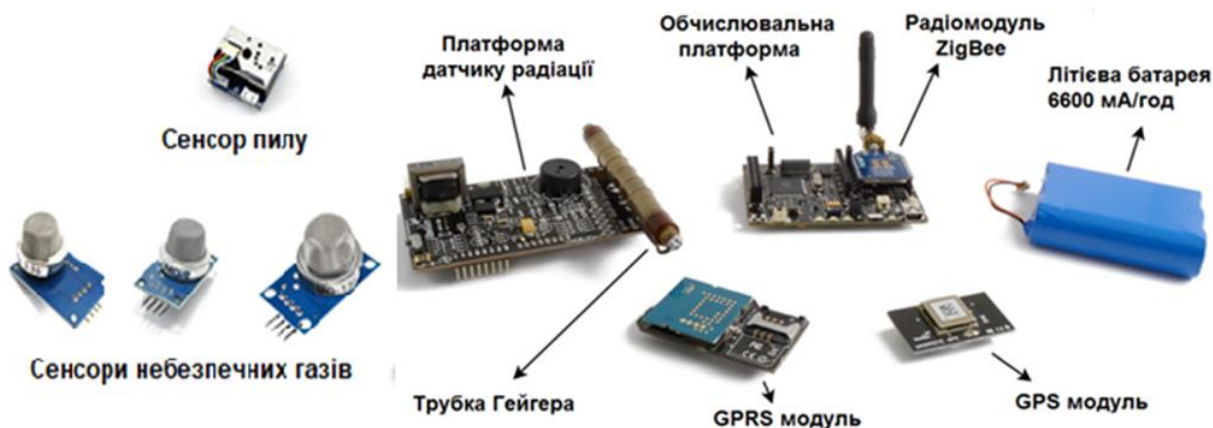
Рисунок 1 – Комплектація апаратної частини програмно-апаратного комплексу
