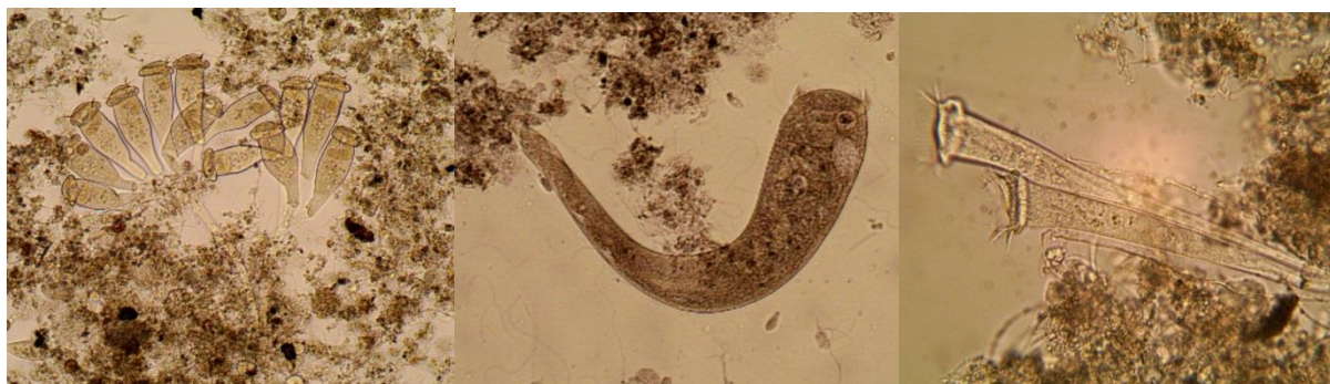
Фото 2 – Результати мікроскопування АМ в аеротенках станції ОС м. Суми
