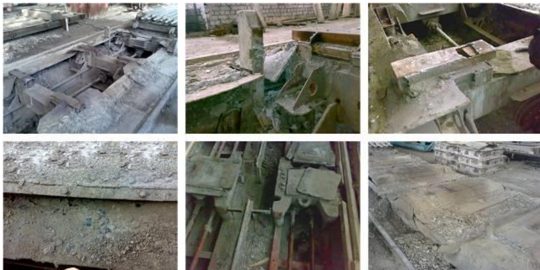
Рис. 2. Фотофіксація відмов робочих органів вібраційних майданчиків
