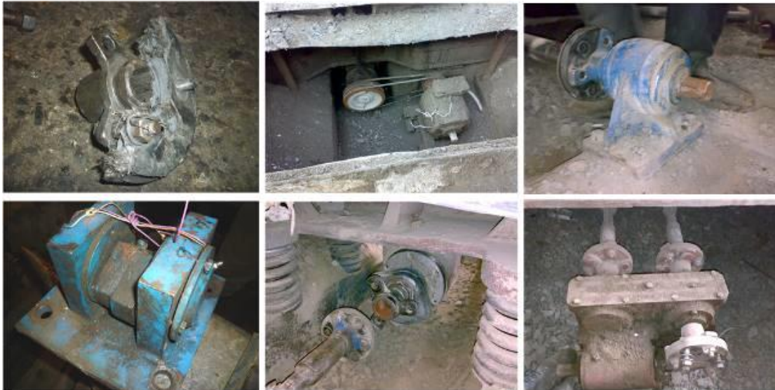
Рис. 1. Фотофіксація відмов механічних вузлів та деталей вібраційних майданчиків
