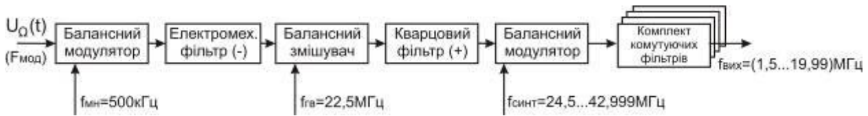
Рисунок 7.18 - Принцип формування та перенесення односмугового сигналу в діапазон робочих частот для радіостанції Р-143
