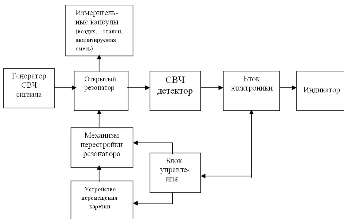
Рис. –Схема измерения многокомпонентной газовой смеси
