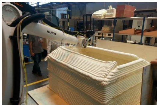
Рис. 4. Принтер на базі промислового маніпулятора KUKA
