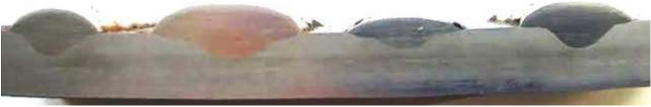
Рисунок 1 – Перерізи наплавлених валиків порошковим дротом ПД 80Х20Р3Т під шаром флюсу [7]
