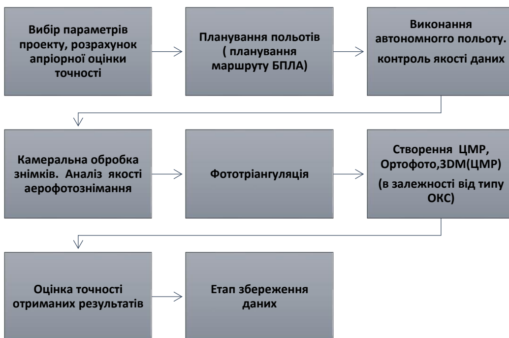
Рис.1 Технологічна схема робочого процесу аерофотознімання ОКС з БПЛА
