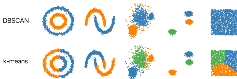
Рис.3. Схематичні зображення порівняння роботи алгоритмів кластеризації kMeans і DBSCAN [3]
