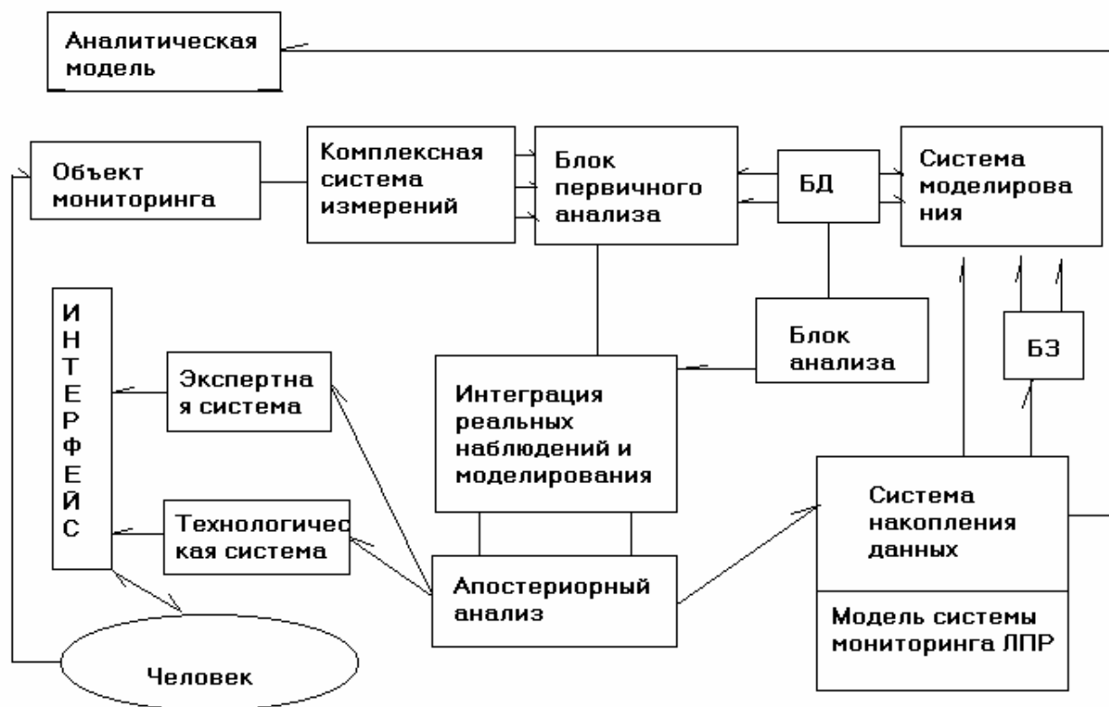
Рис. 2.5 – Структурная схема техногностических систем
