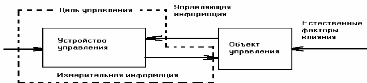
Рис. 2.2 - Теоретическая схема систем мониторинга
