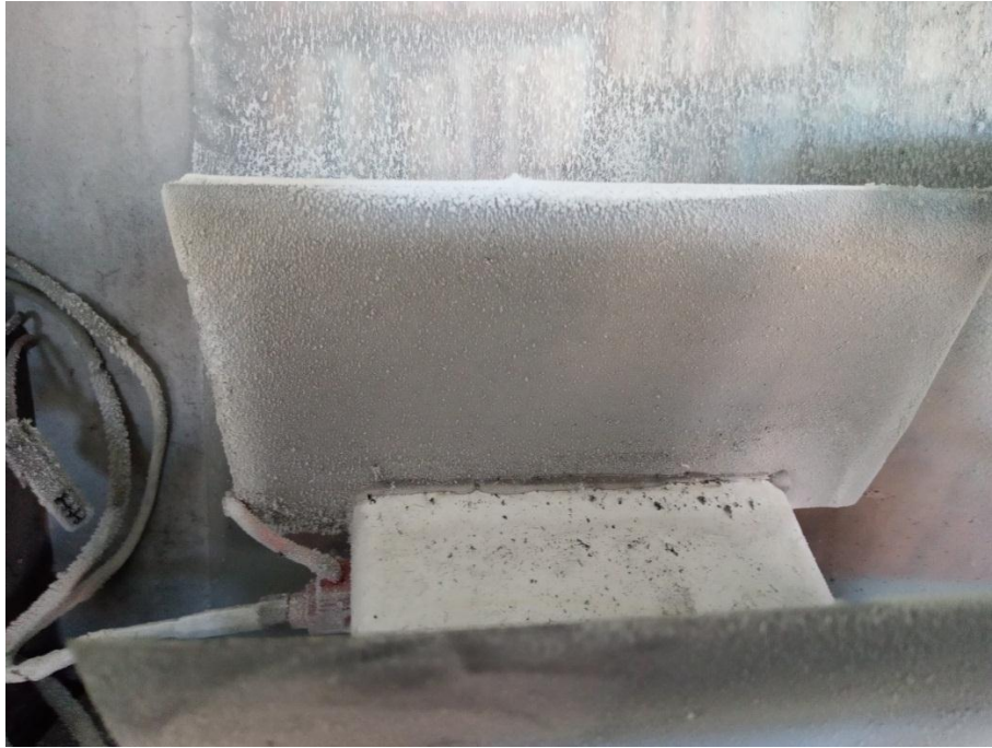
Рис. 2. Нерівномірний розподіл осілих твердих часток по площі пластин-електродів
