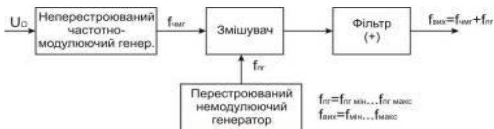
Рисунок 7.25 -Отримання інтервалу робочих частот f_{\text{мін}}-f_{\text{макс}} за допомогою інтерполяційної схеми
