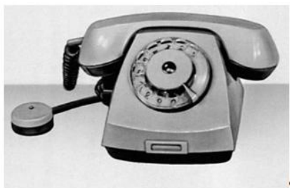
Рисунок 3.9 – Настільний телефонний апарат автоматичної телефонної станції, який забезпечений дисковим номеронабирачем
