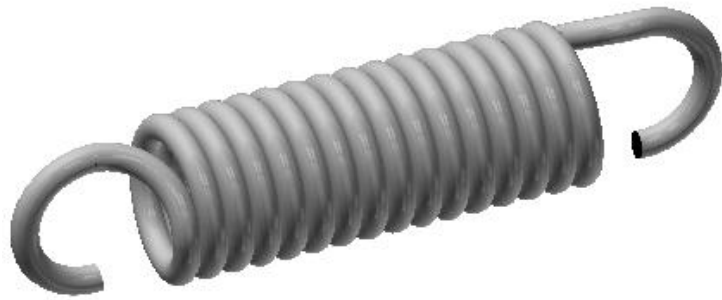
Рис. 1. Параметрична просторова модель пружини розтягання
