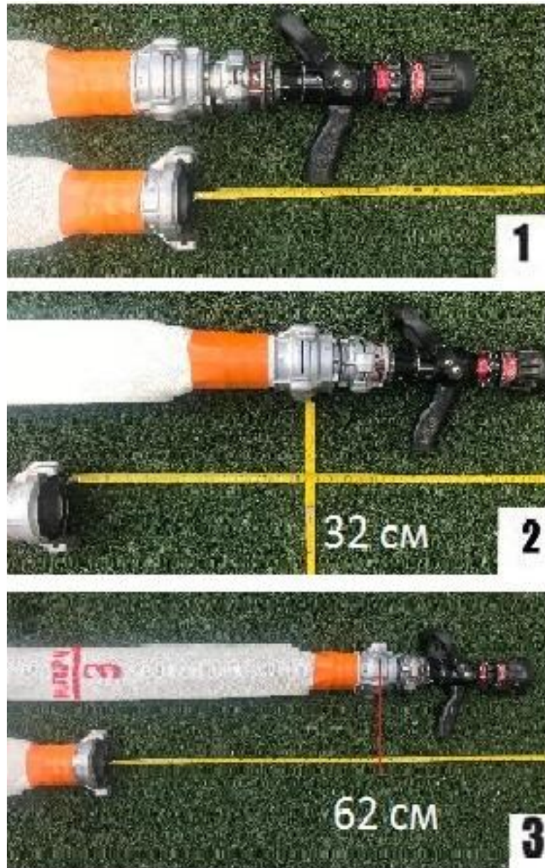
Рис. Вимірювання геометричних параметрів рукавів напірних латексних пожежних діаметром 77 мм типу Т (зміни довжини) при застосуванні пожежного ствола PROTEK 366, 1 – фіксація початкового стану; 2 – порівняльне збільшення довжини рукава при витраті 475 л/хв і тиску 1,0 МПа; 3 – порівняльне збільшення довжини рукава при витраті 115 л/хв і тиску 0,4 МПа.
