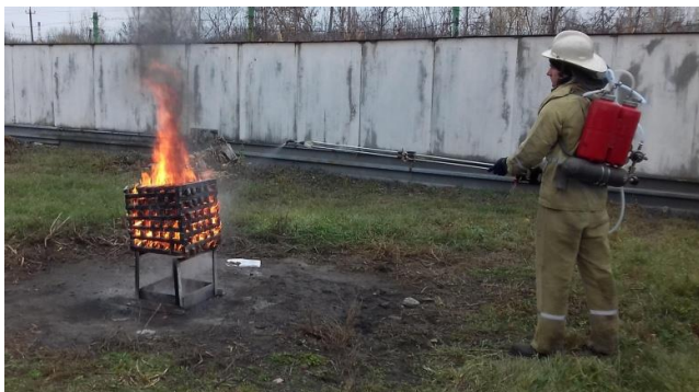
Рис. 1. Гасіння модельного вогнища 1А установкою гасіння гелеутворюючими складами з подовженим стволом колінчастого типу
