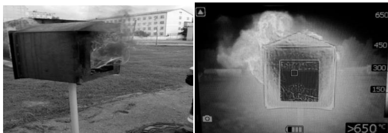
Рисунок 5 - Макет будинку для дослідження розвитку пожежі
