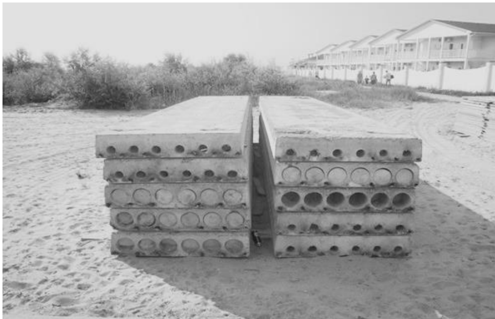
Рис. 1. Загальний вигляд залізобетонної багатопустотної плити перекриття.
