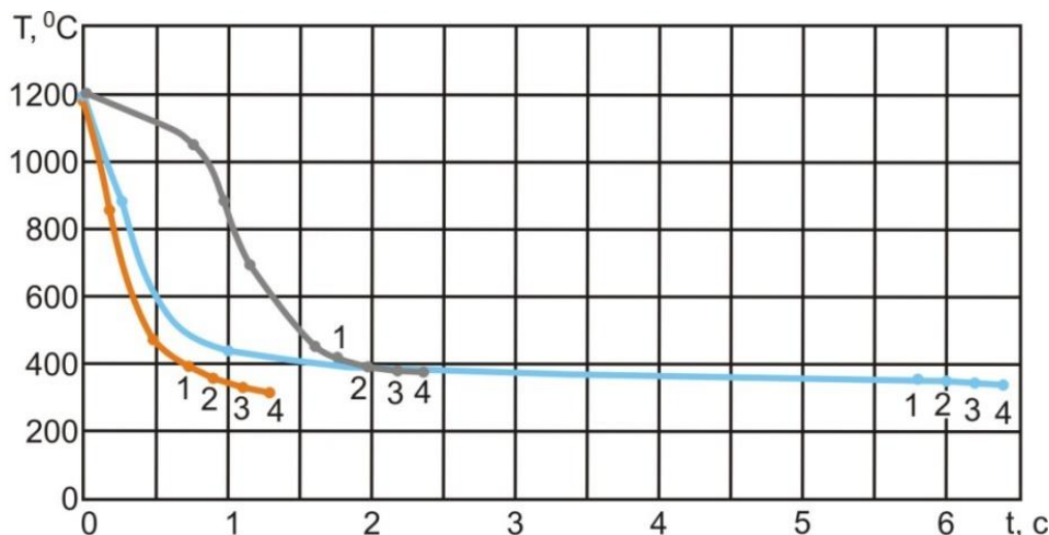
Рисунок 2 – Зависимость температуры газа ( ^\circ\text{C} ) от времени его охлаждения (с):
