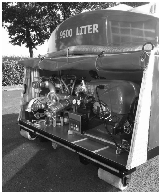
Рисунок 2 – Цистерна на платформі з автономною насосною установкою
