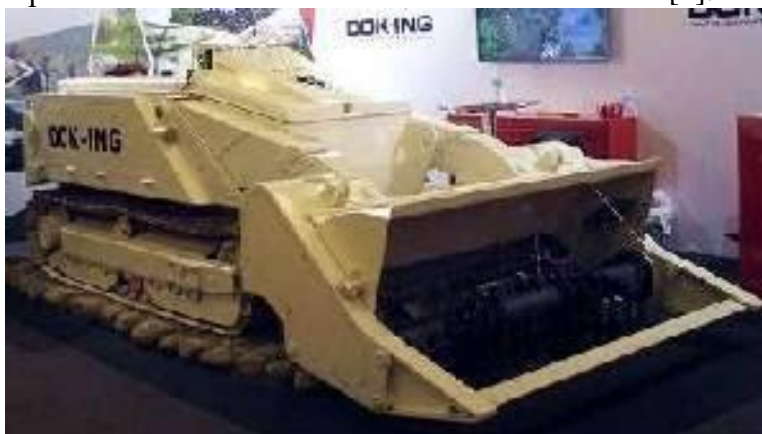
Рис. 2 – Машина для розмінування з дистанційним керуванням MV-4
