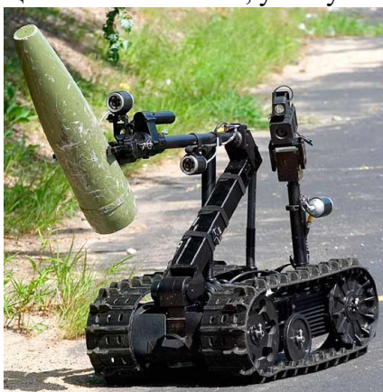
Рис. 1 – Дистанційно керована машина «TALON»
