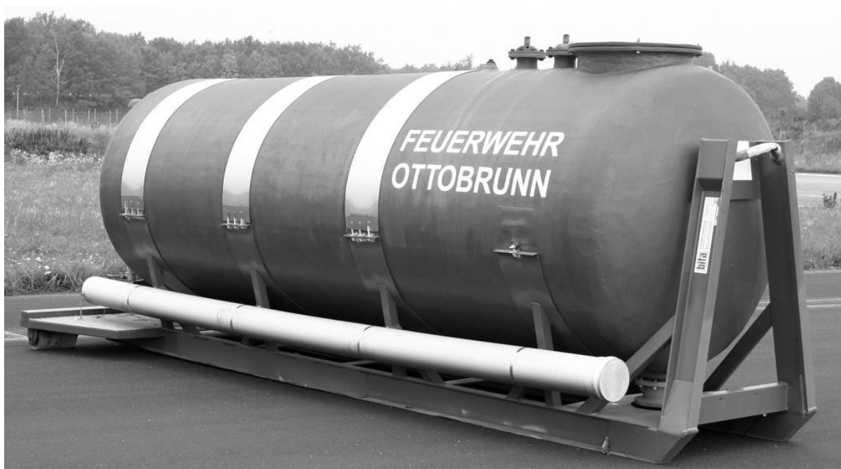
Рисунок 1 – Цистерна для зберігання вогнегасних речовин, яка встановлена на спеціальній рамі
