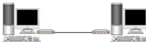
Рис. 3 - З'єднання типу "точка-точка"
