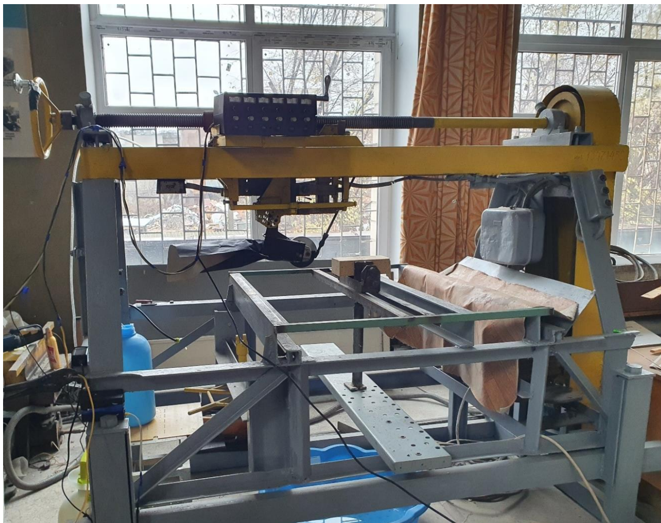
Рисунок 2. Динамометричний стенд реєстрації силового навантаження авторської конструкції КНУБА
