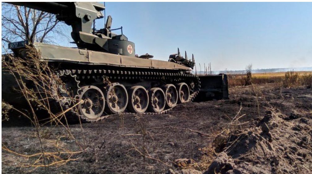
Рис. 1. Інженерна машина розгородження ІМР-2
