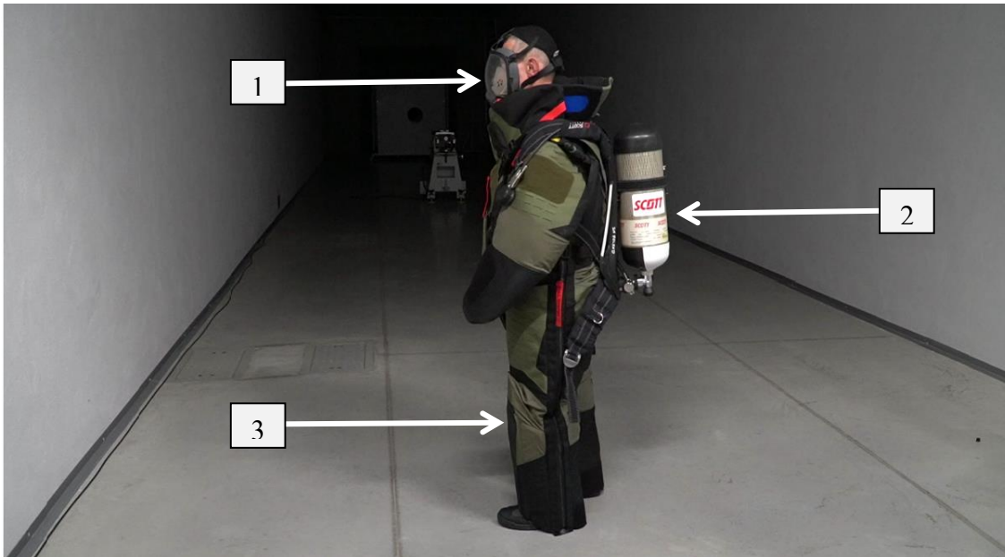
Рис. 1. Костюм EOD ONE польського виробника LUBAWA SA з апаратом на стисненому повітрі SCOTT: 1 – повнолицева маска; 2 – апарат на стисненому повітрі SCOTT; 3 – Костюм EOD ONE
