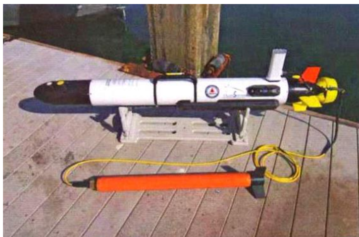
Рис. 1. AUV Iver 3 з магнітометром Marine Magentics
