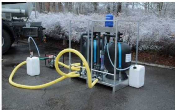
Рис. 1. Автономна водоочисна установка
