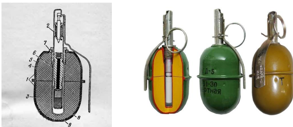
Рис. 1. Будова ручної осколкової гранати дистанційної РГД-5 вагою 0,310 кг: 1 – корпус; 2 – запал УЗРГМ-2; 3 – розривний заряд (ТНТ = 0,110 кг); 4 – ковпак; 5 – вкладиш ковпака; 6 – трубка для запалу; 7 – манжета; 8 – піддон; 9 – вкладиш піддону
