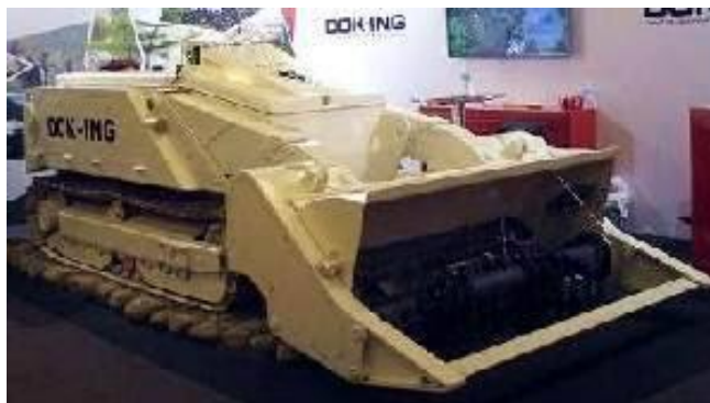
Рис. 2. Машина для розмінування з дистанційним керуванням MV-4
