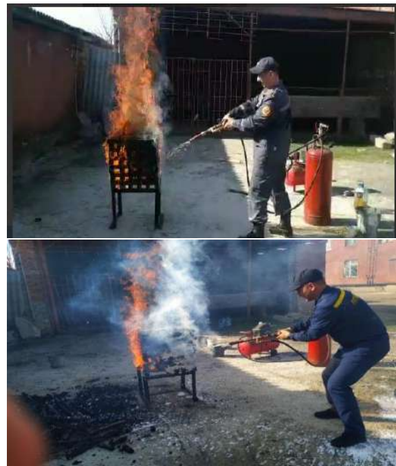
Рис. 7. Експериментальне порівняння вогнегасної ефективності компресійної піни та води [27].
