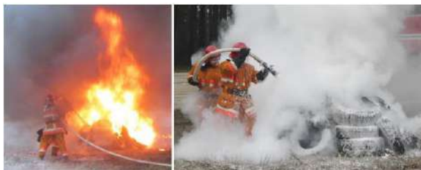
Рис. 6. Дослідження ефективності компресійної піни під час гасіння пожежі класу А [23].
