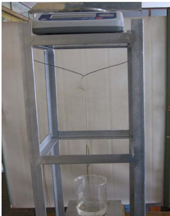
Рис. 1. Установка для определения поверхностного натяжения методом отрыва кольца
