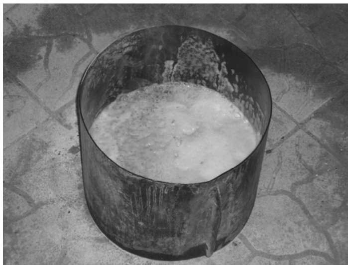
Рис. 1. Пена, образовавшаяся на поверхности бензина после прекращения горения
