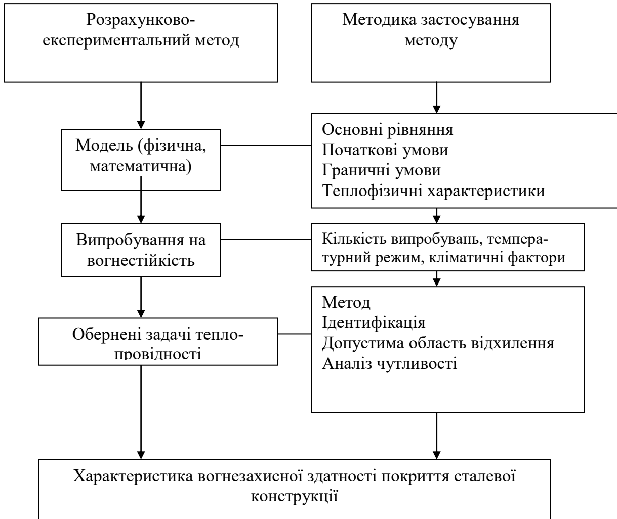
Рис. 3. Розрахунково-експериментальний метод оцінювання вогнестійкості вогнезахисених сталевих конструкцій і алгоритм його застосування
