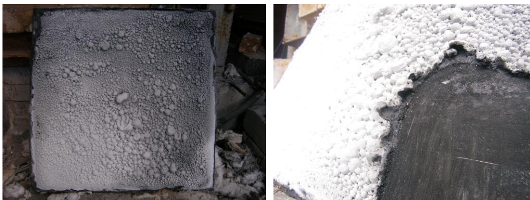
Рисунок 5 – Загальний вигляд сталеві пластини з покриттям «Amotherm Steel Wb» після випробувань.
