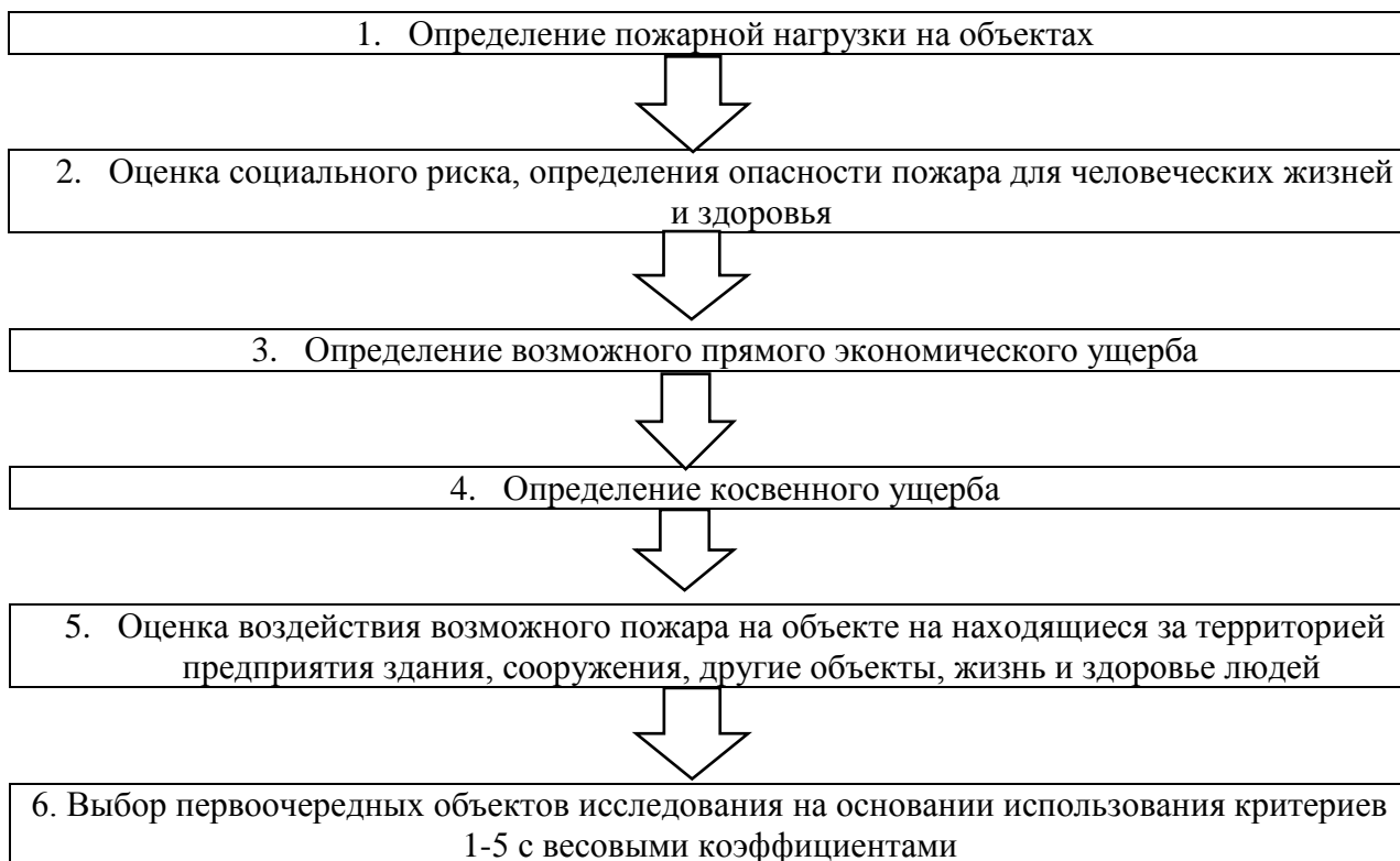
Рисунок 1 – Алгоритм выбора наиболее опасных в пожарном отношении объектов г.Харькова
