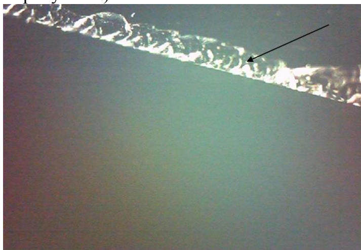
Рисунок 1 – Кромка стекла, образовавшаяся в результате механического разрушения при 50^{\times} кратным увеличением
