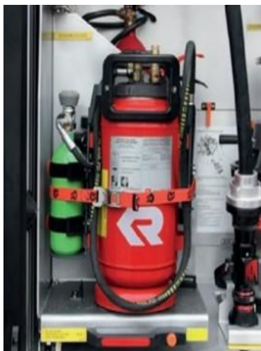
Рис. 1.16 – Переносний ранцевий вогнегасник із компресійною піною POLY PORTEX SL10
