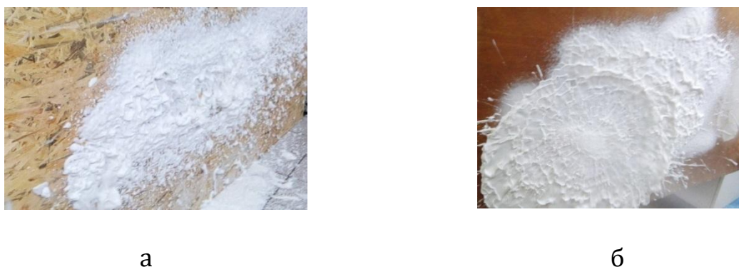
Рис. 2.10 – Вигляд компресійної піни, нанесеної на вертикальну дерев'яну (а) та пластикову (б) поверхню після 240 с витримки. Співвідношення «водний розчин піноутворювача–повітря» складало від 1 до 12 (а) та 1 до 6 (б)
