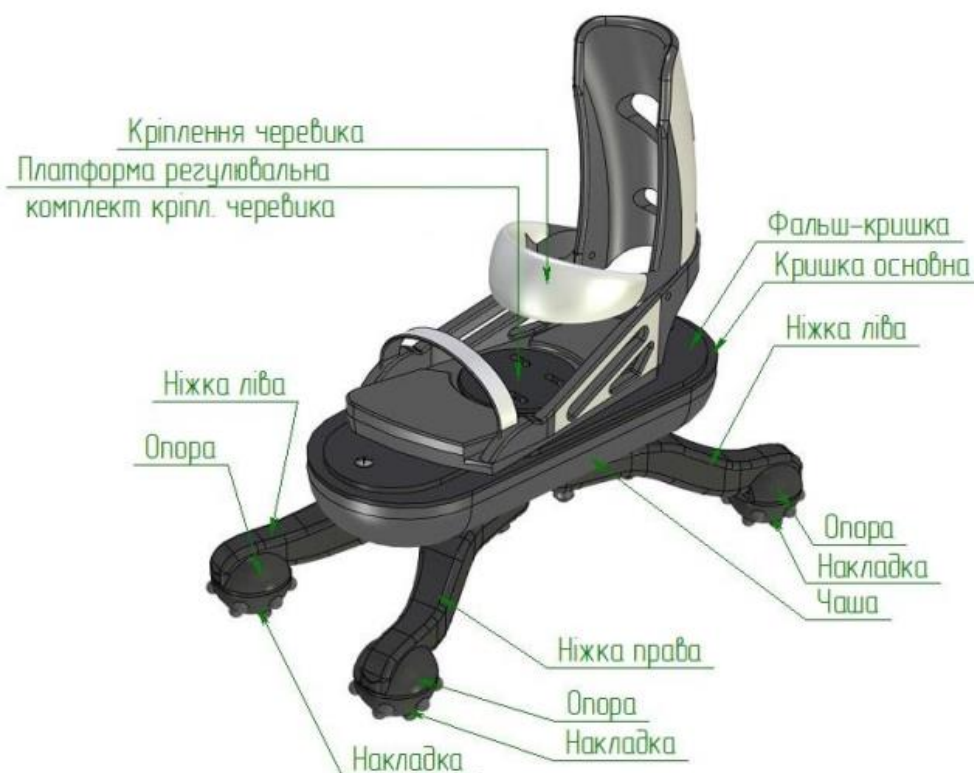
Рис – 1. Системи захисту ніг від протипіхотних мін URC Spider Boot: ніжки ліві; ніжки праві; опора; накладка; чаша; фальш-кришка; кришка основна; втулка розпірна; кріплення черевика; платформа регульовальна кріплення черевика (комплект кріплення черевика).
