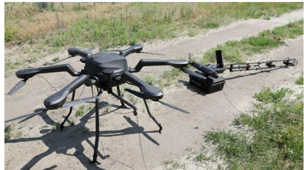
Рис. 3. Повітряний дрон для розмінування
