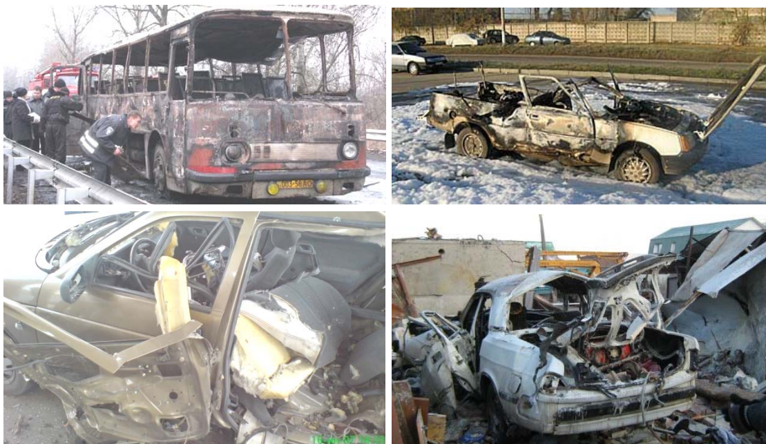
Рис. 1 – Последствия аварийных ситуаций, связанных с газобаллонной системой хранения топлива на автомобиле
