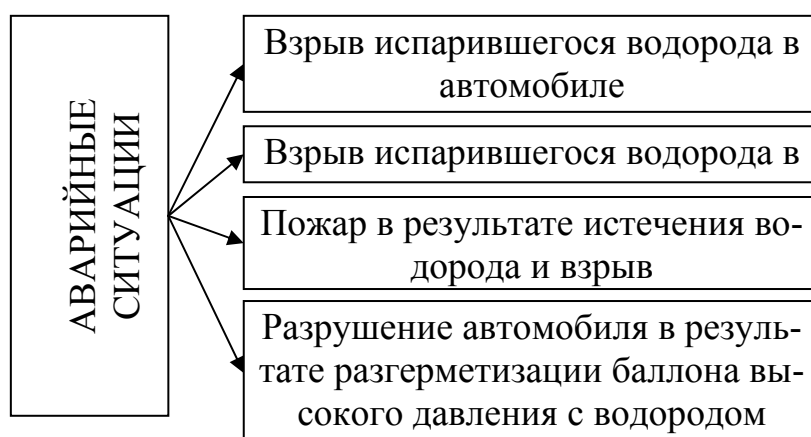
Рис. 2 – Аварийные ситуации, связанные с газобаллонной системой хранения водорода
