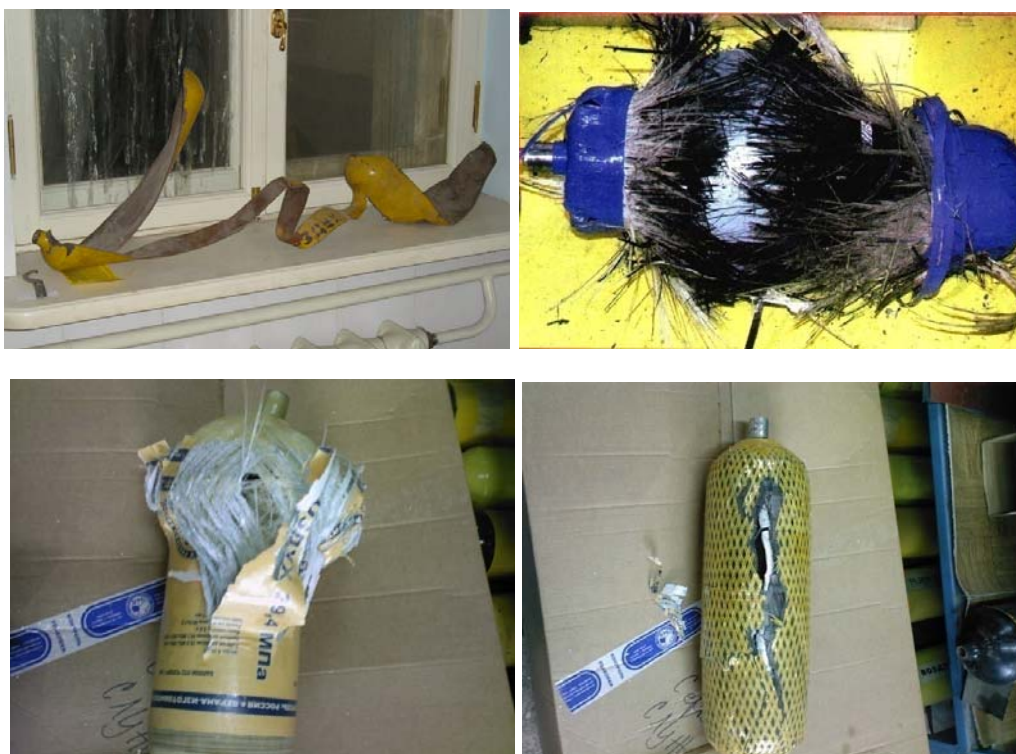
Рис. 1 – Фото разрушенных баллонов
