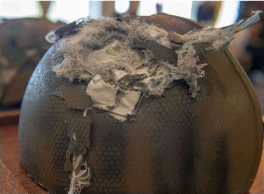
Рис. 4.12. Вигляд шолома після влучання осколків 3 см діаметра
