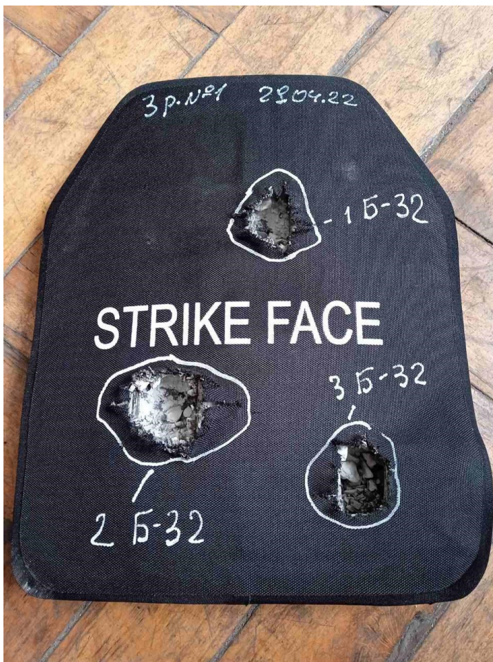
Рис. 4.9. Вигляд керамічної пластини при дії на неї вражаючого чинника
