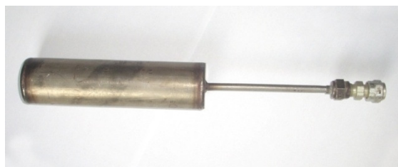
Рис. 1. Фото гидридного патрона
