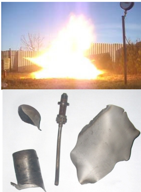
Рис. 5. Фото взрыва и гидридного патрона после взрыва
